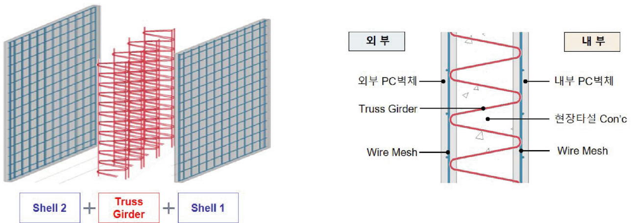
〈그림 1〉 PC 더블월의 제작 방법과 형상
