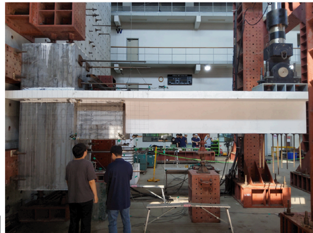
[그림 4] HMB 시스템 구조실험 셋팅
