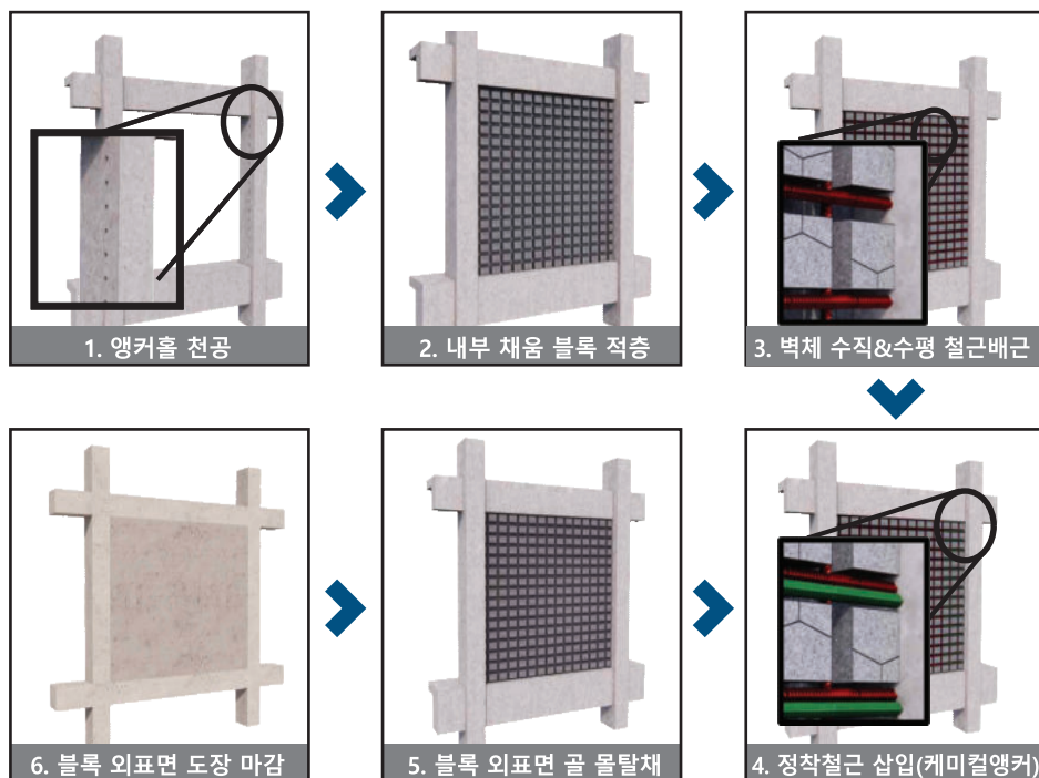
[그림 3] PBS SW 공법의 시공순서
